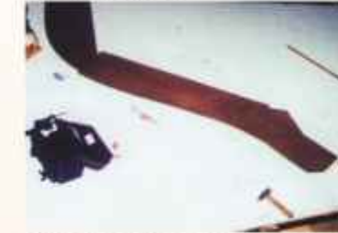
3. Vorbereiten der Spanten
