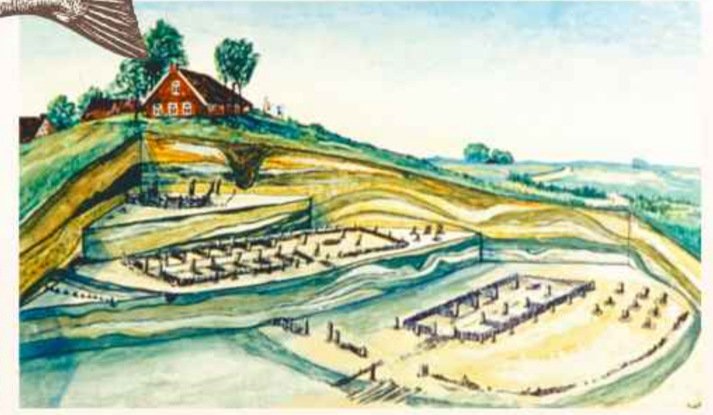
Querschnitt durch eine Warft (Zeichnung: Both, NIHK)
